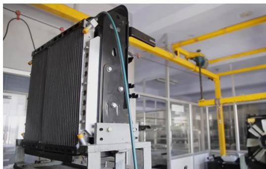
Pruebas de vibración para simular las condiciones reales operativas y en carretera.
