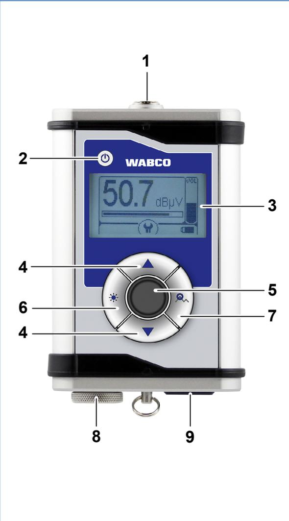
1 Toma de conexión para sondas ultrasónicas
