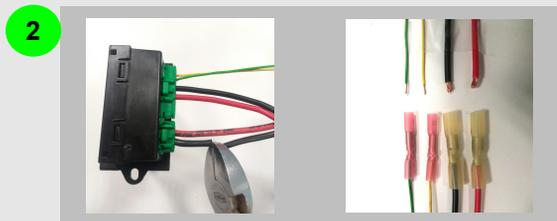
**Para sustituir el cable**, cortar, pelar y unir cada cable con el nuevo conector para evitar confusiones.
