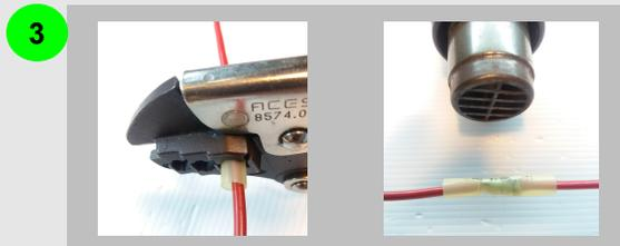
**Engatillar los cables** y calentar la funda para que se produzca el ajuste correcto por retráctilado.
