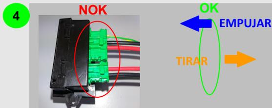
**Comprobar que la conexión es correcta** en ambos conectores, empujando y tirando.
